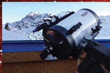
Das Hauptgerät der Sternwarte Simplon-Adler ist ein 40cm-Schmidt-Cassegrain-Teleskop. Dank der Unterstützung durch den Förderverein stand uns die Sternwarte für drei Beobachtungsnächte zur Verfügung.
