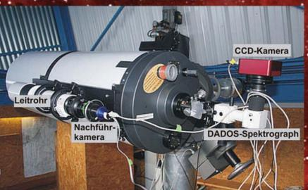
Unser DADOS-Spektrograph war mit einer ATIK-383L-CCD-Kamera zur Aufnahme der Spektren am 16-Zoll-Teleskop montiert. Die Nachführkontrolle feigte eine ALCCD-51L-Guidingcam am Leitrohr.
