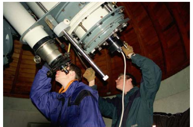
Abb. 6: Der Bolivia-Astrograph wird für CCD-Beobachtungen mit einer ST6-Kamera vorbereitet.
