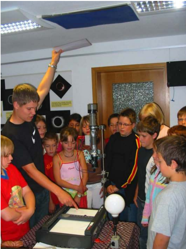
Abb. 4: Ein Schüler unserer Astro-AG demonstriert den Schülerinnen und Schülern einer Grundschulklasse unser Eigenbaugerät zur Messung der Zenithelligkeit. Stellvertretend für eine helle Wolke zieht gerade ein weißes Papierblatt vor dem „blauen Himmel“ (blaue Pappe an der Decke) vorbei. Auf dem Y-T-Schreiber entsteht ein Kurvenverlauf wie im untenstehenden Diagramm bei der Zenithelligkeit gegen 13.00 Uhr und kurz nach 14.30 Uhr.
